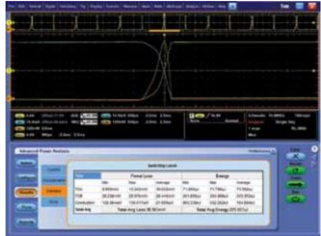
图 8. DPOWPR 自动开关损耗测量，显示结果得到明显改善
