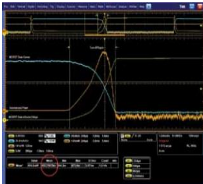
图 4. 选通功能自动测量 MOSFET 开关中的关闭功率损耗
