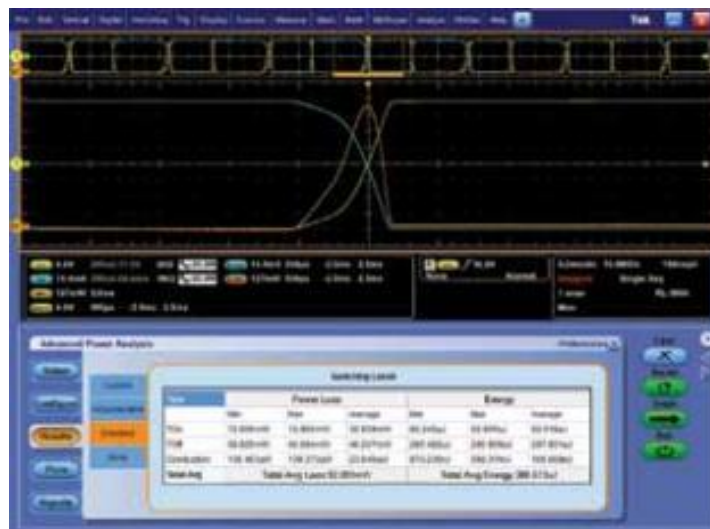
图 5. DPOPWR 自动开关损耗测量
