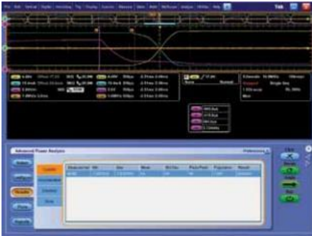
图 7. 自动测量 MOSFET 栅极转换速率
