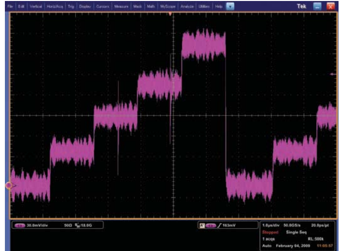
图24. 峰值检测模式使得示波器能够捕获非常短的瞬态异常信号。
