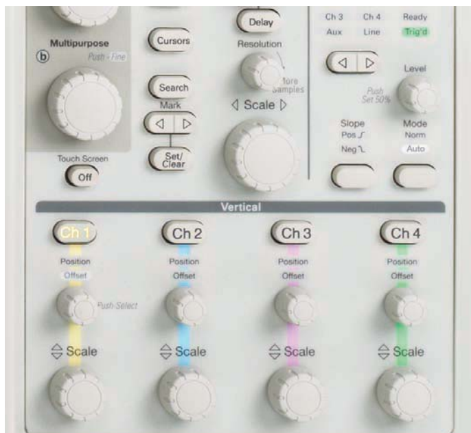
图60. 传统的模拟式旋钮控制着位置、标度、辉度、等等，完全满足您的预期。
