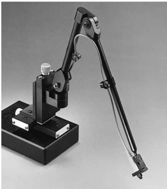
图2.10. 为探测小型设备而设计的探测站实例,如混合电路和IC
