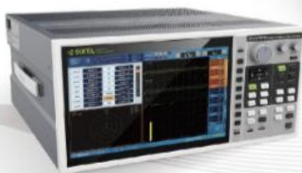
将高精度功率分析仪接入到逆变器直流侧与交流侧，从早到晚每隔 50ms(每秒采集 20 次)采集逆变器全功率期间直流侧输入电压、输入电流及交流侧输出电压和输电电流，分别计算各采集时间点(每分钟)输出功率和输出效率，为直观展现逆变器效率，可将不同负载情况下转换效率拟合得到输出效率分布趋势图，同时可根据不同负载率工况的转换效率计算出逆变器平均加权总效率。在需要进行大电流测量时配合上电流传感器能够实现多种电流等级的精确测量。
