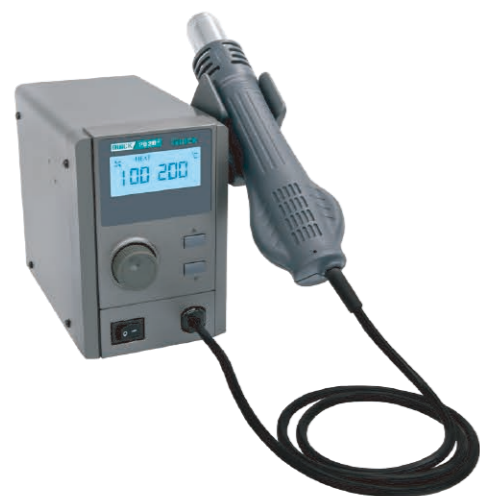
QUICK/2020+ 无铅热风拆焊台
