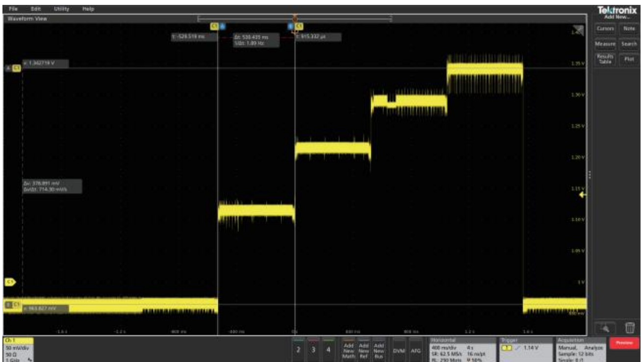
图 11. 在频率提高时相应扩大输入电压的器件实例。许多 AC 耦合滤波器会漏掉步进间的 \sim 2 Hz 频率成分
