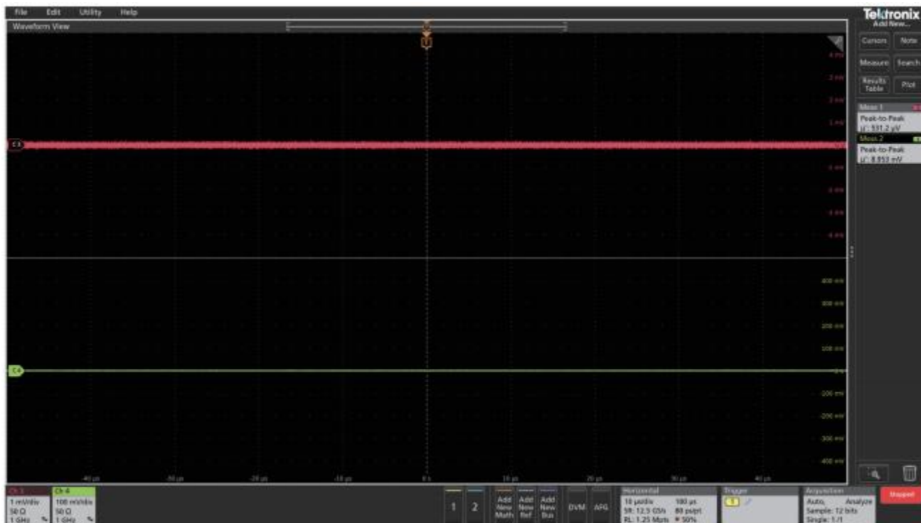
图 7. 垂直标度对测得随机噪声的影响。这两条通道都没有连接输入。通道 3 在 1 mV/div 时的峰峰值噪声为 521.2 mV，通道 4 在 100mV/div 时的峰峰值噪声为 8.953 mV。这比通道 4 上报告的噪声多出来大约 17 倍。注意，对通道 4，8.953mV 不到满刻度电压的 1%
