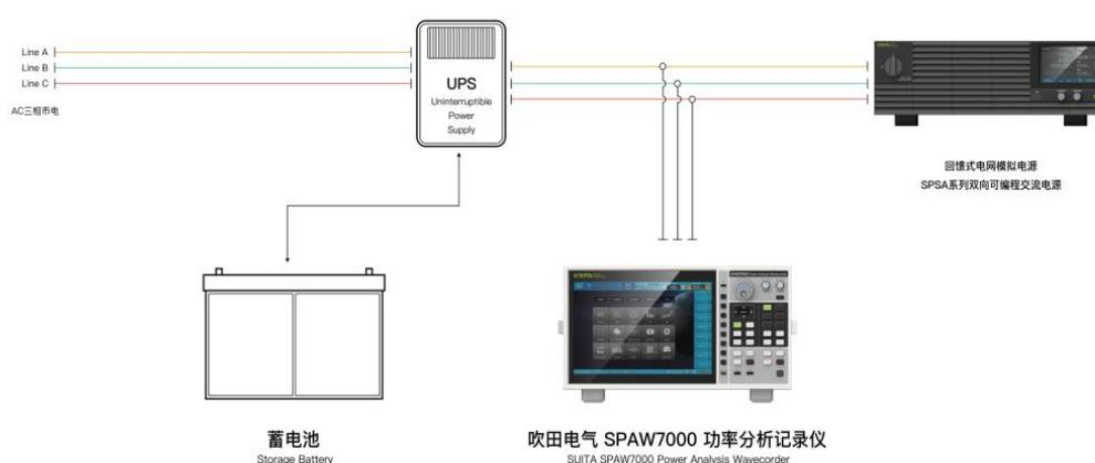
为了准确测试 UPS 输出，需要模拟各种负载。为了更好地模拟平时的工作状态，我们将回馈式交流电源连接到 UPS 输出端，以便检测在转变过程中 UPS 系统是否会对正在工作中的设备产生不好的影响。除此之外，回馈式交流电源作为可编程电源，可以模拟各种电子负载，同时还具有谐波模式，可以模拟在负载出现故障时是否会对 UPS 输出产生相应影响。
